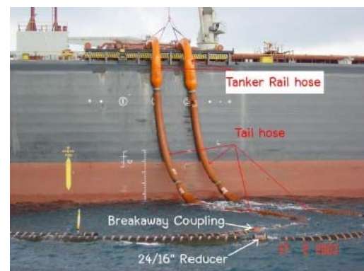
รูปที่ 3-33 อุปกรณ์ตัดแยกน้ำมันฉุกเฉิน (Break Away Coupling)
