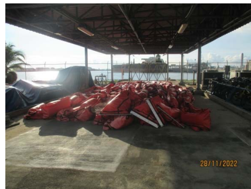
รูปที่ 3-12 พุนักน้ำมันแบบไม่สุบลม
