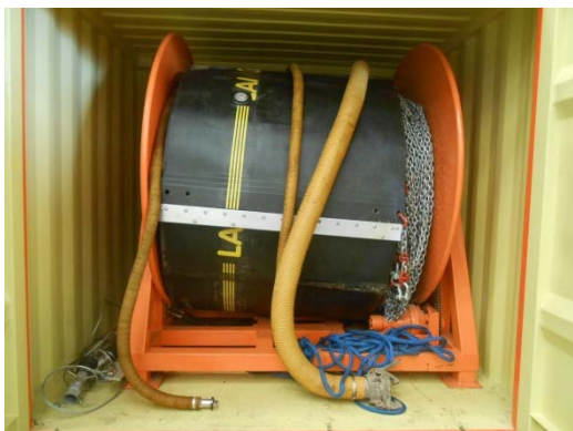
รูปที่ 3-11 พุนักน้ำมันแบบสุบลม
